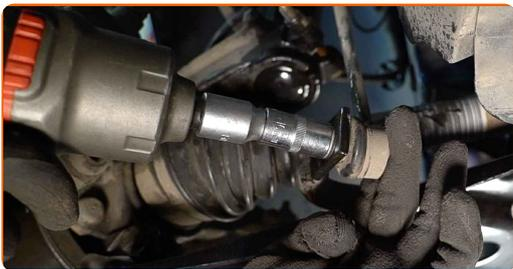
**8** Skruva loss fästena som håller fast krängningshämmaren med stötdämparen. Använd hylsnyckel Nr16.
