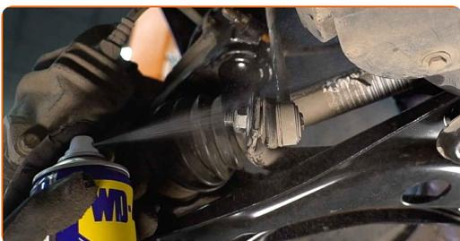
**7** Skruva loss fästningarna som håller ihop krängningshämmarens länk till armen. Använd hylsnyckel Nr16.
