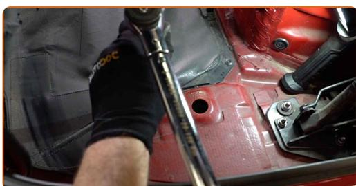
**34** Montera monteringslocket på stötdämparen.
