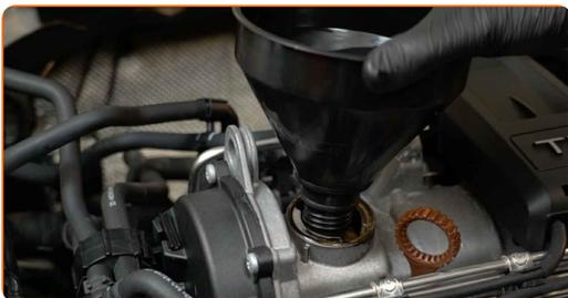
**22** Häll olja i motorn via påfyllningshålet. Den erforderliga mängden olja är: 3.8 l.
