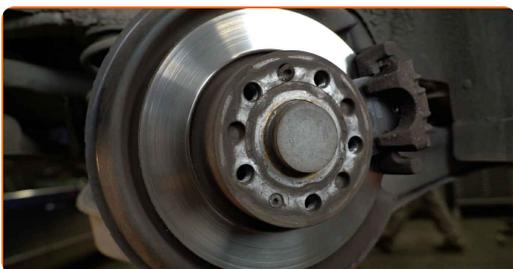
**7** Rengör bultarna till bromsoket. Använd en stålborste. Använd WD-40 aerosol.
