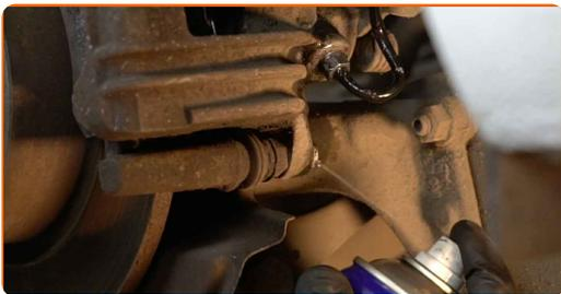
**8** Skruva loss bromsokets fästelement. Använd kombinyckel Nr 13. Använd kombinyckel Nr 15.
