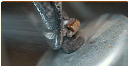
**9** Lossa på fästningsklamporna för bränsleslangen. Använd en plattmejsel.
