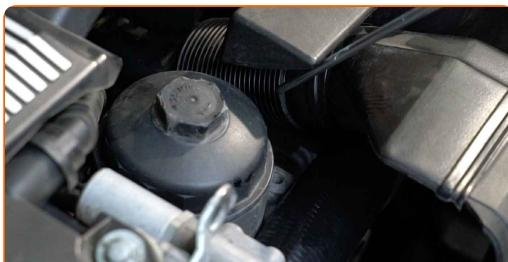
5 Skruva loss filterhusets lock och dess gamla filterelement. Använd hylsnyckel Nr36. Använd en spärrnyckel.
