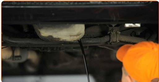
**Utbyte: motorolja och filter – AUDI 100 C2 Avant (43). AUTODOC
