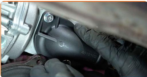
13 Dra åt fästena till termostatens hölje. Använd hylsnyckel Nr10. Använd en momentnyckel. Dra åt den till 13 Nm vridmoment.
