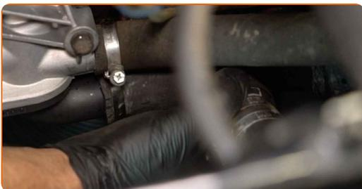
15 Säkra kylvätskeslangens klämma. Använd hylsnyckel Nr7. Använd en spärrnyckel.
