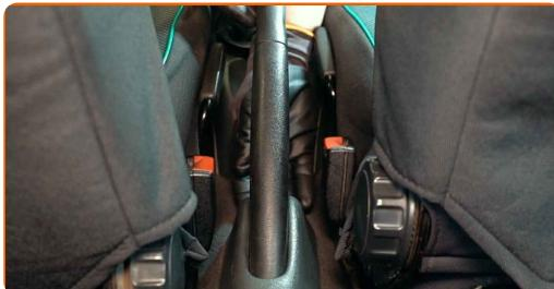
2 Lossa parkeringsbromsens kabel. Använd kombinyckel Nr 10.
