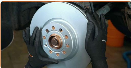
**24** Dra åt bromsskivans fästelement. Använd Torx T30. Använd en momentnyckel. Dra åt den till 4 Nm vridmoment.
