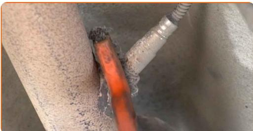
**7** Skruva loss lambdasondens fäste. Använd en 22 mm hylsa för lambdasond. Använd en spärrnyckel.
