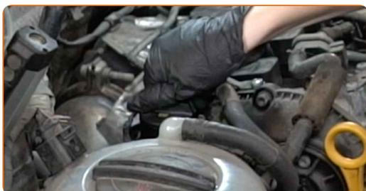
**31** Kör motorn i några minuter. Stäng av motorn när oljetrycks lampan slocknar.
