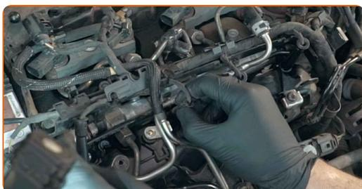
**18** Behandla kabelknippets kontaktdon. Använd dielektrikfett.
