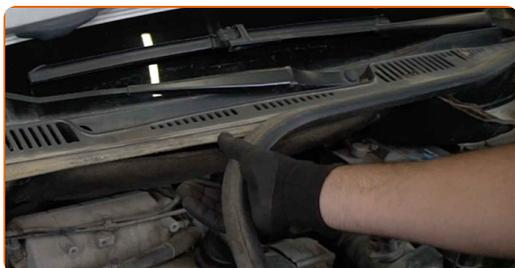
4 Rengör fästena på vindrutetorkarens torpedplåt. Använd en stålborste. Använd WD-40 aerosol.
