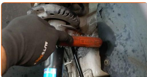
**16** Skruva loss fästena som håller fast krängningshämmaren med stötdämparen. Använd hylsnyckel Nr19. Använd en spärrnyckel.
