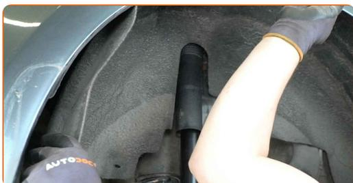
**42** Skruva i fästena till hjulhusets innerskärm. Använd Torx T25. Använd en spärrnyckel.
