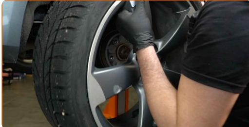
8 Rengör bultarna till bromsoket. Använd en stålborste. Använd WD-40 aerosol.
