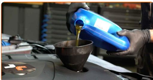
Utbyte: motorolja och filter – AUDI A4 B8 Avant (8K5). Tips från AUTODOCs experter:
