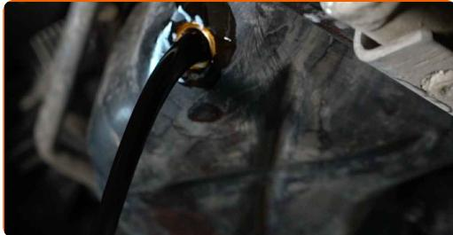
Utbyte: motorolja och filter – AUDI A4 B8 Avant (8K5). AUTODOC
