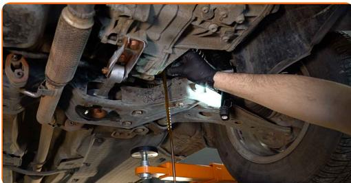
Utbyte: transmissionsolja till manuell växellåda – AUDI A6 Avant (4B5, C5).
