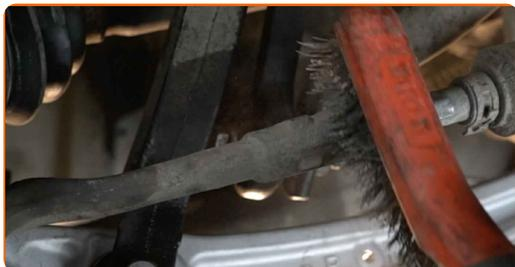
**9** Vid demontering så ska du märka eller mäta exakta positionen för kulletet på parallellstaget eller räkna antalet varv för att förhindra feljustering efteråt. Använd ett skjutmått.
