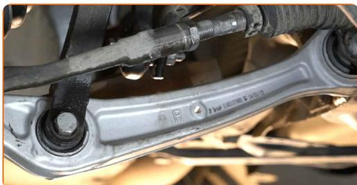
**12** Skruva loss änden från parallellstaget.
