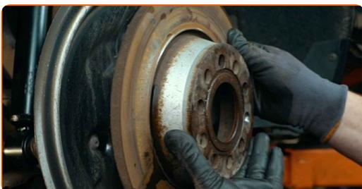
**19** Avlägsna navlagrets skyddslock. Använd en hammare. Använd en kofot.
