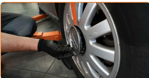
**5** Skruva loss navets låsmutter. Använd en 1-3/16 tumms 12-kantad hylsnyckel.
