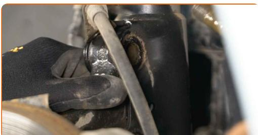
**18** Koppla loss styrspindeln från fjäderbenet.
