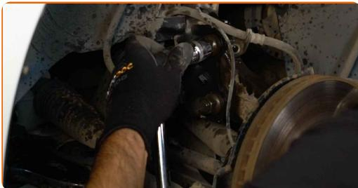
**16** Förse styrspindeln med stöd. Använd en hydraulisk domkraft.
