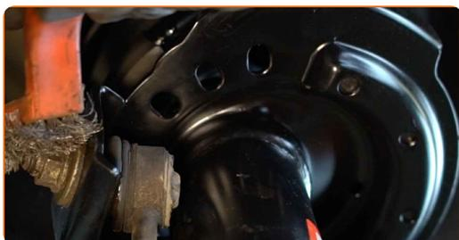
**7** Skruva loss fästena som håller fast krängningshämaren med stötdämparen. Använd kombinyckel Nr 16.
