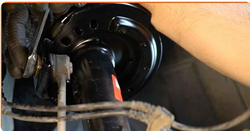
**8** Skrova loss fästningar som kopplar stabiliseringslänken till krängningshämaren. Använd kombinyckel Nr 16.
