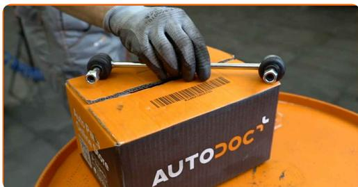
**12** Dra åt fästningar som kopplar stabiliseringslänken till krängningshämmaren. Använd kombinyckel Nr 16. Använd hylsnyckel Nr16. Använd en momentnyckel. Dra åt den till 60 Nm vridmoment.
