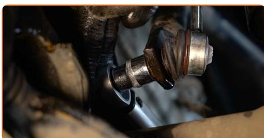
**13** Dra åt fästningarna som kopplar stabiliseringslänken till stötdämparen. Använd kombinyckel Nr 16. Använd hylsnyckel Nr16. Använd en momentnyckel. Dra åt den till 60 Nm vridmoment.
