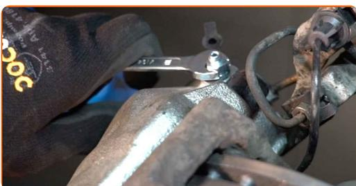
**33** Koppla bromsluftaren till bromsluftarskruven.
