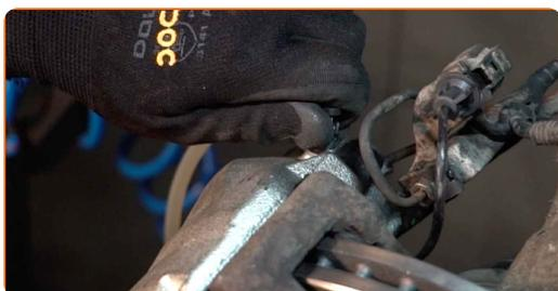
**37** Dra åt bromsokets luftningskruv. Använd hylsnyckel Nr10. Använd en momentnyckel. Dra åt den till 9 Nm vridmoment.
