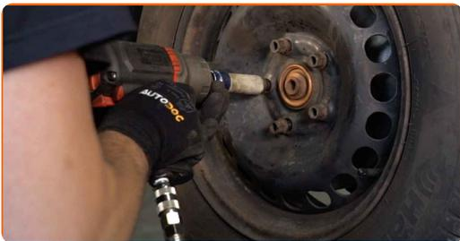
**42** Sänk bilen och arbeta i omvänd ordning, dra åt hjulbultarna. Använd en momentnyckel. Dra åt den till 120 Nm vridmoment.
