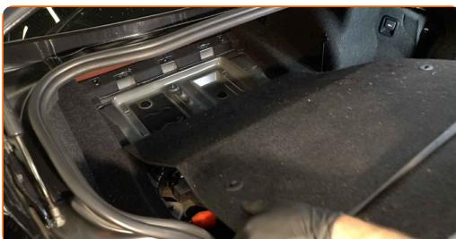
**4** Skruva loss fästelementet från mellersta skyddspanelen av plast. Använd en Phillips skravmejsel. Använd ett verktyg för panelclips. Använd Torx T40. Använd en spärrnyckel.
