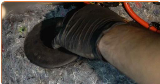
**29** Dra åt stötdämpparens nedre fästelement. Använd hylsnyckel Nr14. Använd en momentnyckel. Dra åt den till 60 Nm vridmoment.
