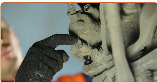
**21** Installera bromsokets spärrfjäder. Använd en plattmejsel.
