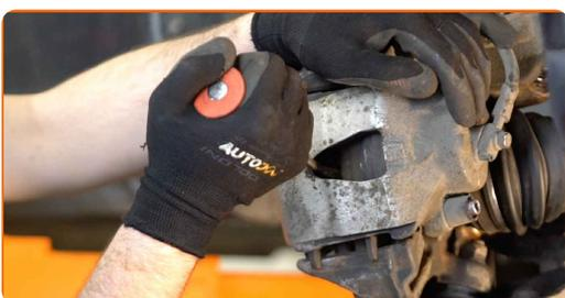
**10** Rengör bultarna till bromsoket. Använd en stålborste. Använd WD-40 aerosol.
