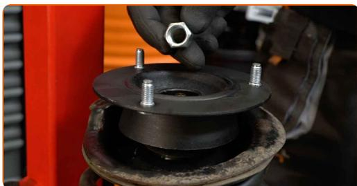
**27** Dra åt muttern på stötdämparens kolvstång. Använd hylsnyckel Nr19. Använd hylsnyckel Nr9. Använd en momentnyckel. Dra åt den till 52 Nm vridmoment.
