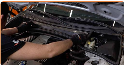
17 Skruva fast fästena till skyddet till kabinfiltret.
