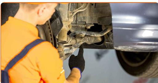
7 Lossa på låsmuttern som håller fast parallellstagsändan med parallellstaget. Använd kombinyckel Nr 24.
