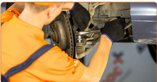
**10** Koppla bort parallellstagsänden från styrspindel. Använd en kulled avdragare. Använd en hammare.
