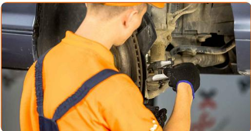
**11** Skruva loss änden från parallellstaget. Använd kombinyckel Nr 13. Använd kombinyckel Nr 22.
