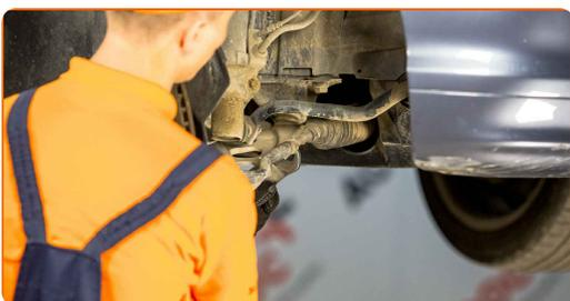
**8** Rengör fästningarna som kopplar styrstagänden till styrspindel. Använd en stålborste. Använd WD-40 aerosol.
