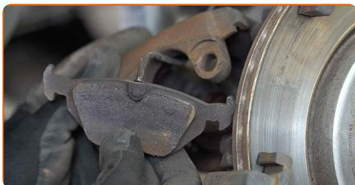
**13** Koppla loss bromsbeläggsslitagevarnaren. Använd en kofot.
