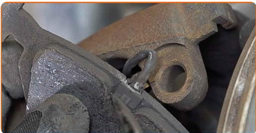
**19** Installera bromsoket och justera den. Använd HEX Nr. H7. Använd en momentnyckel. Dra åt den till 30 Nm vridmoment.
