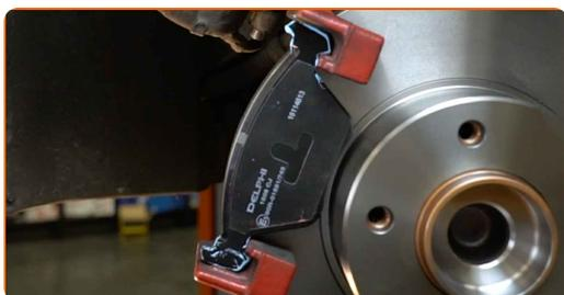
**31** Installera bromsoket och justera den. Använd HEX Nr. H7. Använd en momentnyckel. Dra åt den till 30 Nm vridmoment.
