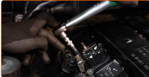
**35** Behandla tändspolekontakte med elektronikspray. Använd dielektrikfett.
