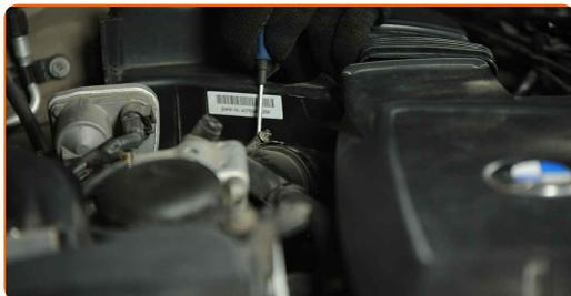
6 Koppla bort luftinsugsröret från luftfilterhuset. Använd en plattmejsel.
