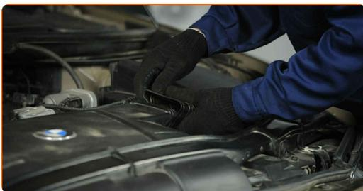
**4** Plugga ur luftflödesgivaren. Använd en plattmejsel.
