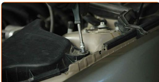
8 Skruva loss klämman som fäster luftfilterslangen i gasspjället. Använd en plattmejsel.
