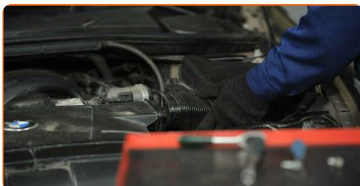
7 Skruva loss filterhusets fästbultar. Använd hylsnyckel Nr10. Använd en spärrnyckel.
