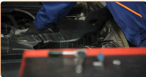
10 Lossa fästskruvorna på luftfilterhållaren. Använd Torx T25. Använd en spärrnyckel.
