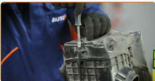
11 Ta av filterlocket. Använd en plattmejsel.
