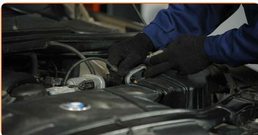
5 Ta loss slangklämman på luftintaget. Använd en plattmejsel.
