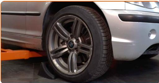
**3** Lossa på hjulmonterings bultar. Använd hjulmutterhylsor nr. 17
