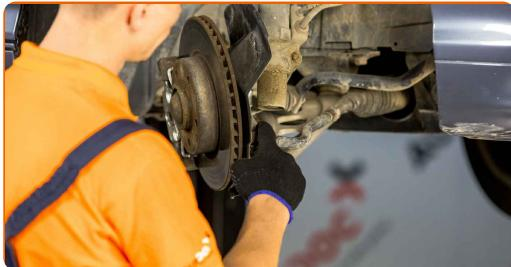
9 Skruva loss fästmuttern från styrspindelns ände. Använd hylsnyckel Nr18. Använd en spärrnyckel.
