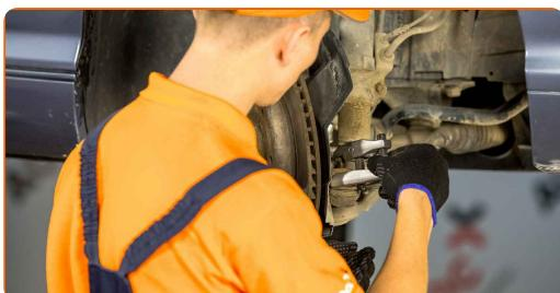
11 Skruva loss änden från parallelstaget. Använd kombinyckel Nr 13. Använd kombinyckel Nr 22.
