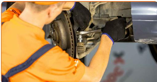
10 Koppla bort parallelstagsänden från styrspindeln. Använd en kulled avdragare. Använd en hammare.
