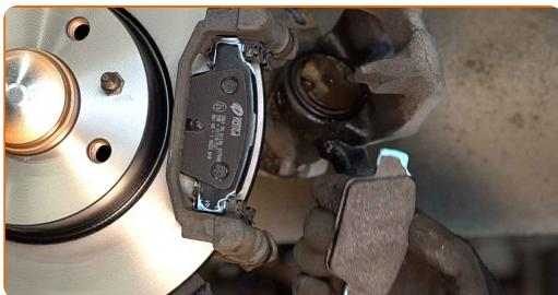
**30** Installera bromsoket och justera den. Använd hylsnyckel Nr13. Använd en momentnyckel. Dra åt den till 30 Nm vridmoment.
