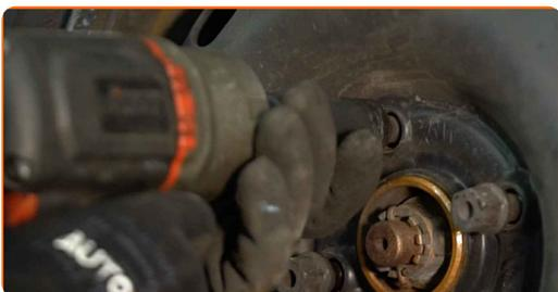
**37** Sänk bilen och arbeta i omvänd ordning, dra åt hjulbultarna. Använd en momentnyckel. Dra åt den till 110 Nm vridmoment.
