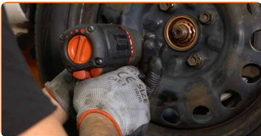
**33** Sänk bilen och arbeta i omvänd ordning, dra åt hjulbultarna. Använd hjulmutterhylsor nr. 17 Använd en momentnyckel. Dra åt den till 100 Nm vridmoment.
