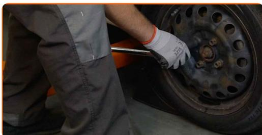
**3** Hög bilens främre del och säkra fästdelarna.
