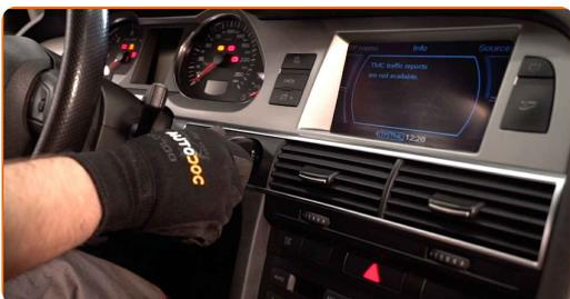
**19** Sätt på luftkonditioneringen. Detta är nödvändigt för att säkerställa att komponenten fungerar korrekt.
