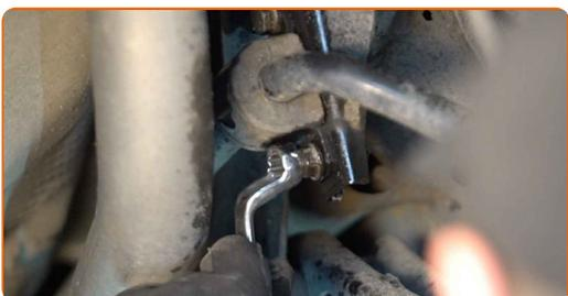
**10** Skruva loss fästningarna som håller ihop krängningshämmarens länk till armen. Använd kombinyckel Nr 15. Använd hylsnyckel Nr15. Använd en spärrnyckel.
