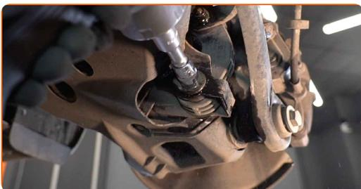
**8** Rengör fästningarna på stabiliseringsbussningarnas konsol. Använd en stålborste. Använd WD-40 aerosol.
