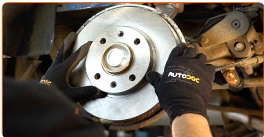
**28** Dra åt bromsskivans fästelement. Använd Torx T30. Använd en momentnyckel. Dra åt den till 9 Nm vridmoment.
