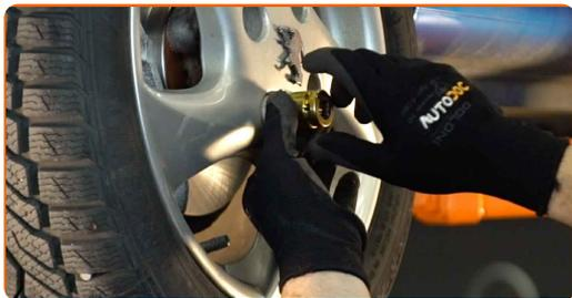
**38** Sänk bilen och arbeta i omvänd ordning, dra åt hjulbultarna. Använd en momentnyckel. Dra åt den till 100 Nm vridmoment.
