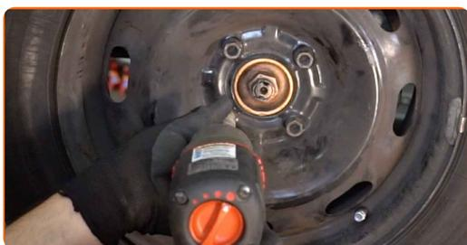
**32** Sänk bilen och arbeta i omvänd ordning, dra åt hjulbultarna. Använd en momentnyckel. Dra åt den till 90 Nm vridmoment.
