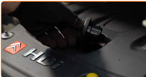
**4** Skruva loss oljefiltret. Använd hylsnyckel 74/76-15F.
