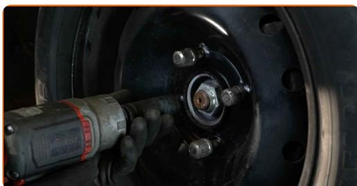
**24** Sänk bilen och arbeta i omvänd ordning, dra åt hjulbultarna. Använd hjulmutterhylsor nr. 19 Använd en momentnyckel. Dra åt den till 90 Nm vridmoment.
