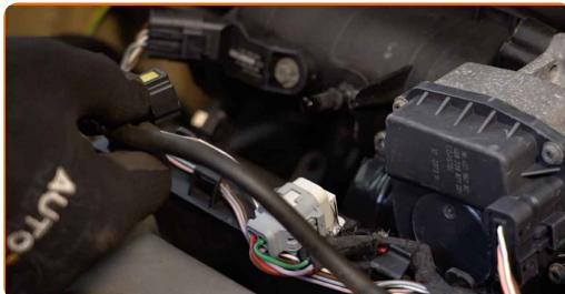
4 Koppla bort vevhusets ventilationsslang från insugningsröret.
