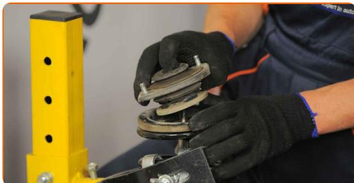
**31** Dra åt muttern på stötdämparens kolvstång. Använd hylsnyckel Nr19. Använd en momentnyckel. Dra åt den till 55 Nm vridmoment.
