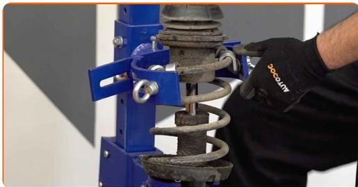
**21** Behandla stötdämparstängan. Använd en stålborste. Använd WD-40 aerosol.
