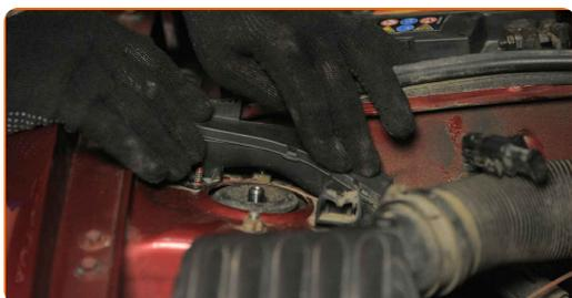
**38** Skruva i fästena på motorns kablagefäste. Använd hylsnyckel Nr10. Använd en spärrnyckel.
