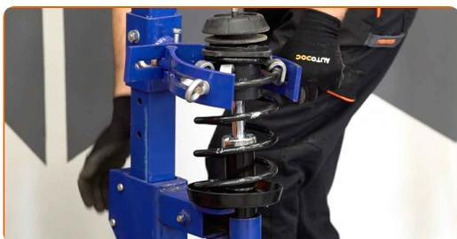
**33** Ta bort det monterade fjäderbenet.
