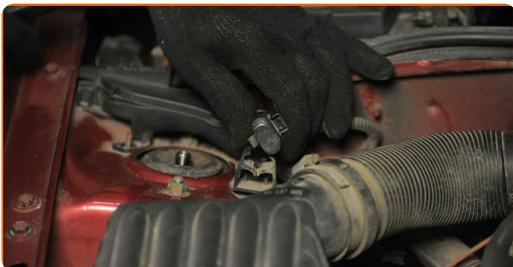
**14** Skruva loss fästena på motorns kablagefäste. Använd hylsnyckel Nr10. Använd en spärrnyckel.
