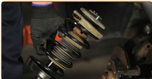
**35** Skruva loss toppfästen från stötdämparmonteringen.
