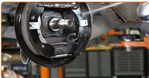
**16** Installera bromstrumman som är monterad med hjulnavlagret.
