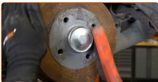
**21** Behandla ytan där hjulfälgen kommer i kontakt med bromsstrumman. Använd keramiskt fett.
