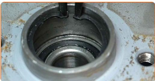
11 Pressa ut hjulnavets lager. Använd en universalsats för demontering/montering av bussningar och lager.
