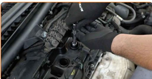
**12** Skruva fast och dra åt de nya tändstiften. Använd tändstiftsmutter nr. 14. Använd en momentnyckel. Dra åt den till 25 Nm vridmoment.
