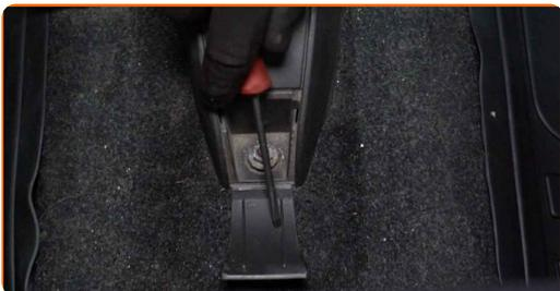
**10** Skruva loss dem främre fästningar för den lägre mitten konsolen. Använd hylsnyckel Nr10. Använd en spärrnyckel.
