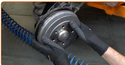
**20** Skruva i bromstrummans fäste. Använd hylsnyckel Nr12. Använd en spärrnyckel.
