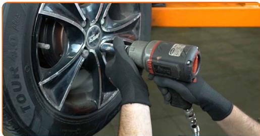
**29** Sänk bilen och arbeta i omvänd ordning, dra åt hjulbultarna. Använd hjulmutterhylsor nr. 17 Använd en momentnyckel. Dra åt den till 98 Nm vridmoment.
