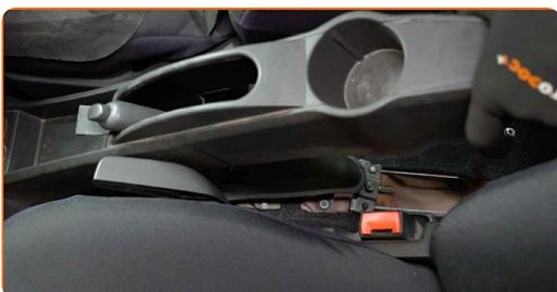
**12** Lossa parkeringsbromsens kabel. Använd kombinyckel Nr 10.
