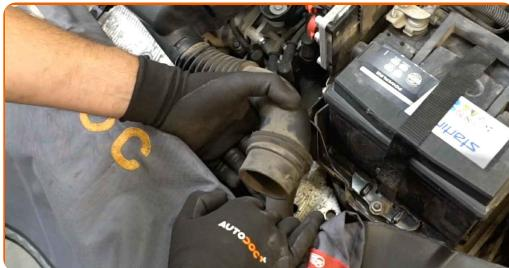
4 Lossa fästsprövarna på luftfilterhållaren. Använd hylsnyckel Nr10. Använd en spärrnyckel.
